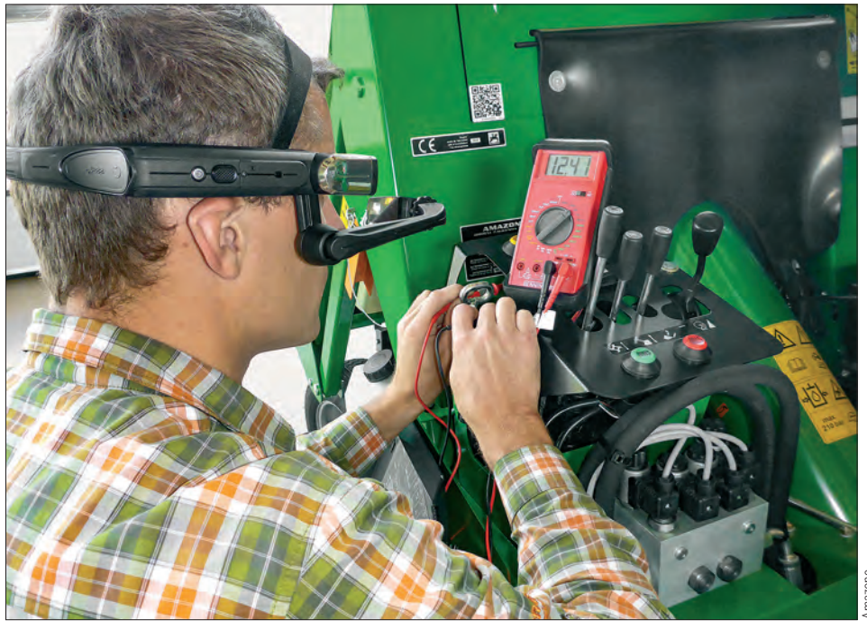
Servicetechniker bei der Ausführung einer SmartInstruction am Profihopper.
